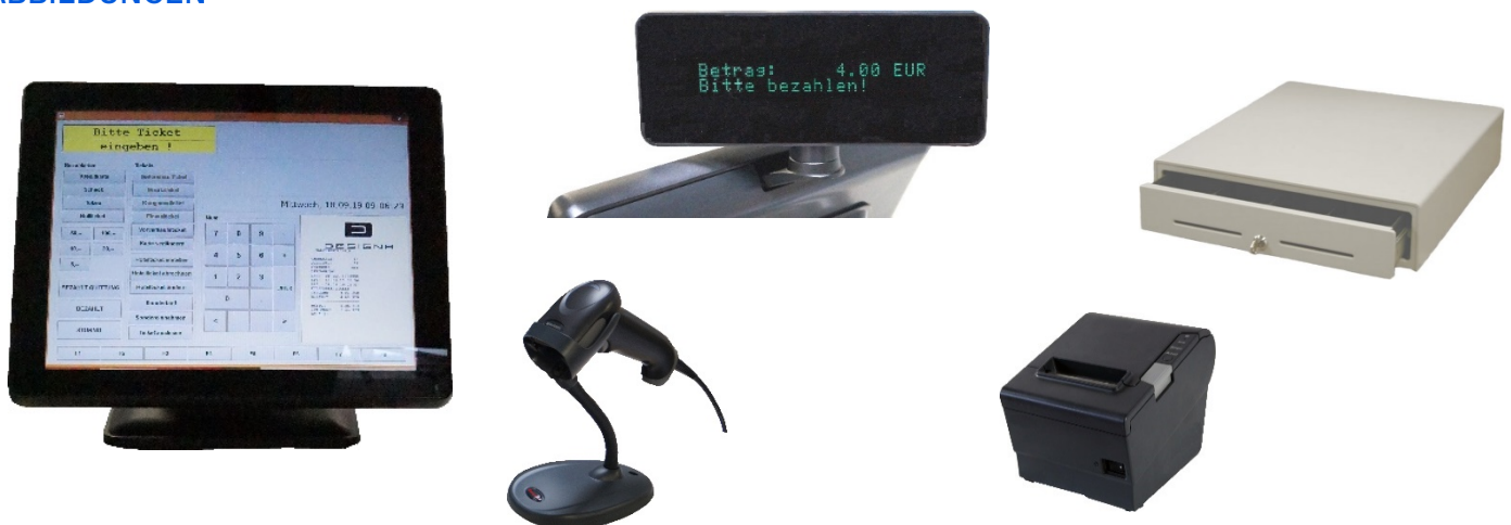
Von links nach rechts: PAY manual touch station, Barcode-Kartenleser, Externe Kundenanzeige (Option), Quittungsdrucker, Kassenschublade (Option)
